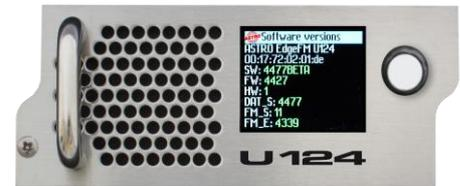
Das U 124 dient zur Umsetzung von vier IP Multicastgruppen eines Gigabit Ethernet MPEG Transport-Stroms in 16 Standard FM-Programme.
